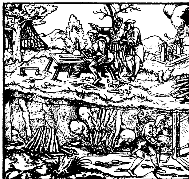
Dobývací metoda zvaná sázení ohněm
