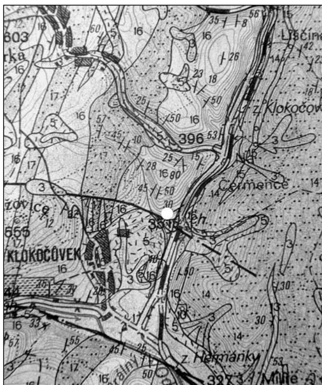
Na výřezu z Geologické mapy ČR (originální měřítko 1 : 50 000) je patrné, že lokalitou prochází zlom západovýchodního směru. Lokalita je vyznačena bílým bodem.
